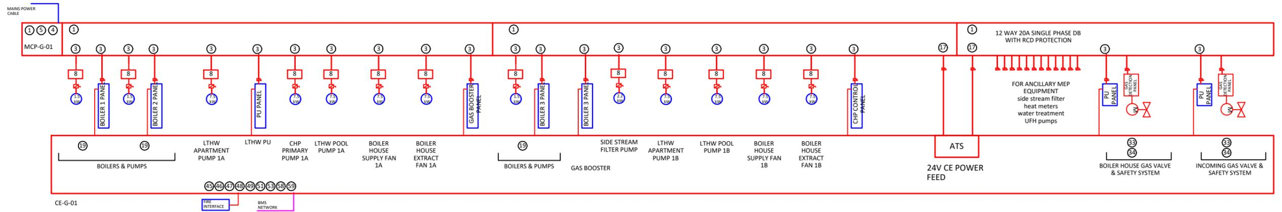
PULSED OUTPUT WIRED TO EACH CONDENSER CONTROLLER
